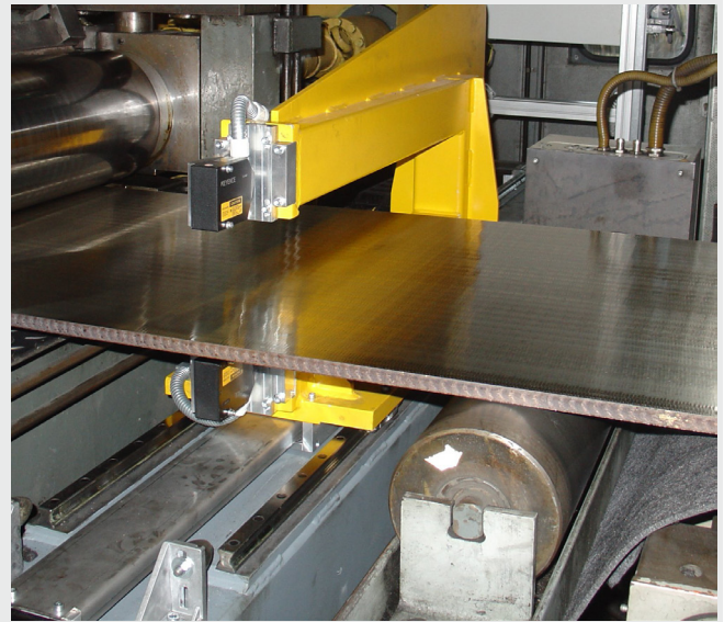
Dickenmessung in der Linie | Inline Thickness Measurement
