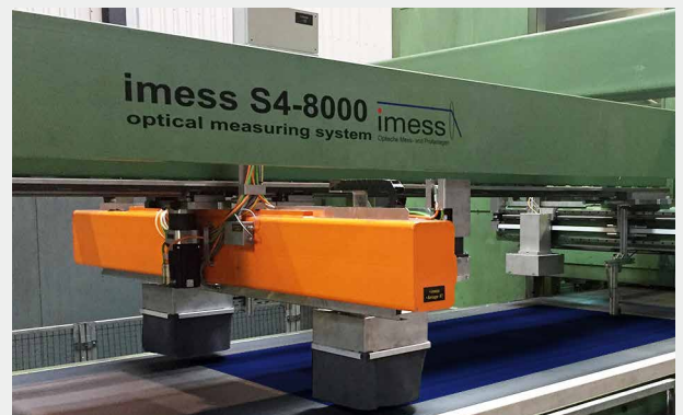
Inline-Messung der Tafelgeometrie in Querteilanlagen
