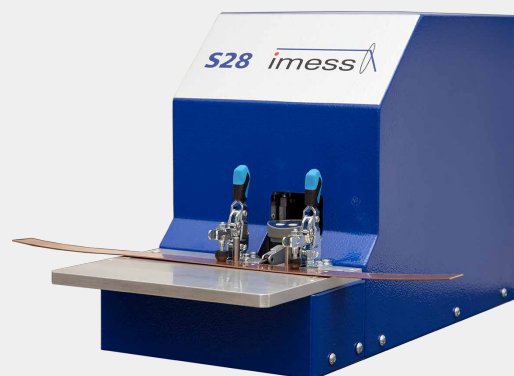
kompaktes Tischgerät zur Gratmessung
